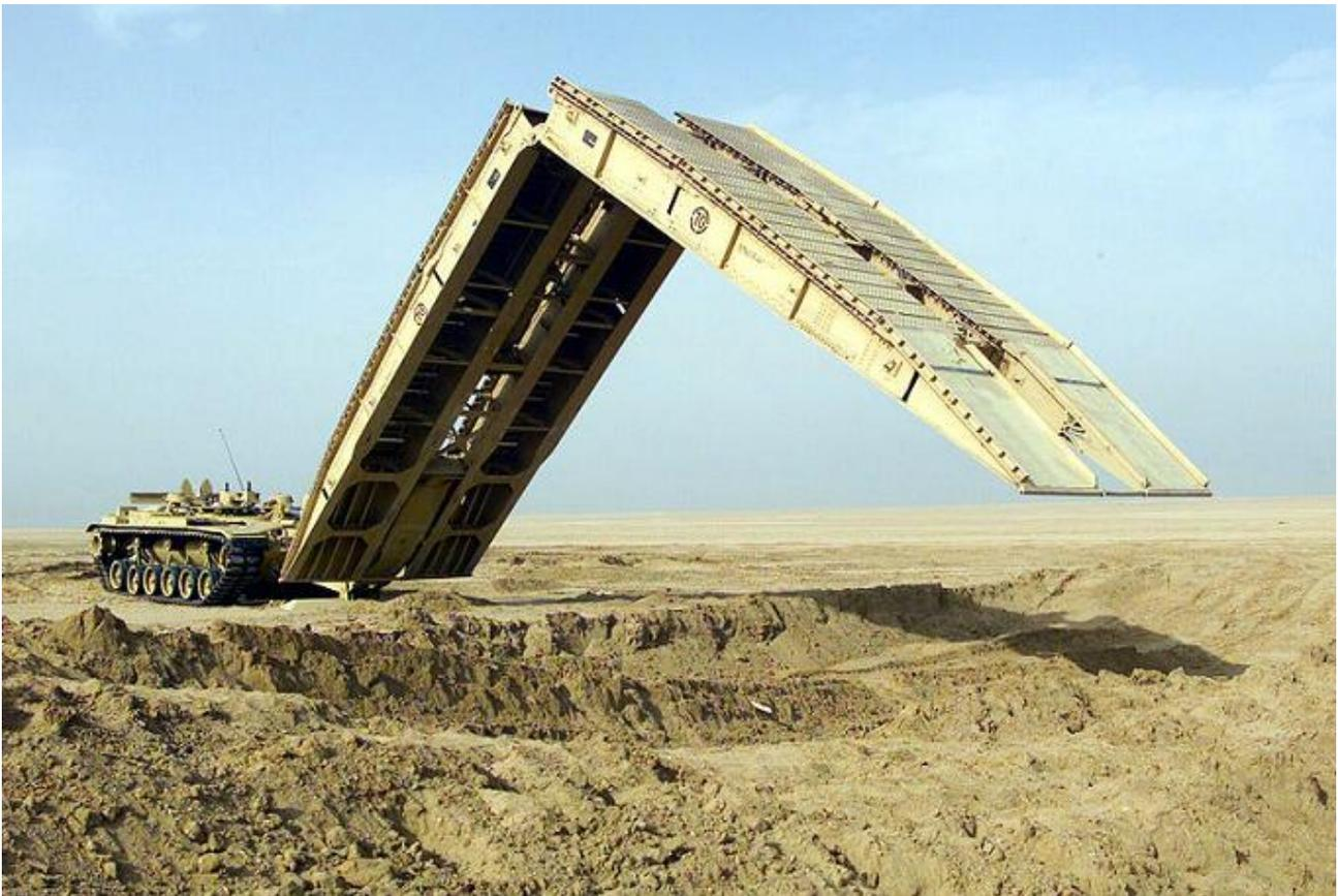
L'M60 Armored Vehicle Launched Bridge (AVLB) è un veicolo blindato basato sullo scafo del carro armato principale M60 Patton, e utilizzato per il lancio e il recupero di un ponte a forbice di 60 piedi (18 m).
